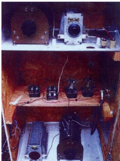
**Figura 5 • Dettaglio degli accordatori.** I due accordatori sono costruiti su vassoi di alluminio di recupero. Sul vassoio superiore trova posto l'accordatore per i 160 metri, in quello centrale i relay, e in quello inferiore, l'accordatore per gli 80 metri. La porta può essere bloccata con un lucchetto per motivi di sicurezza
